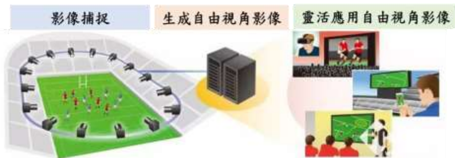
圖 35. 自由視角技術的運作原理 6
